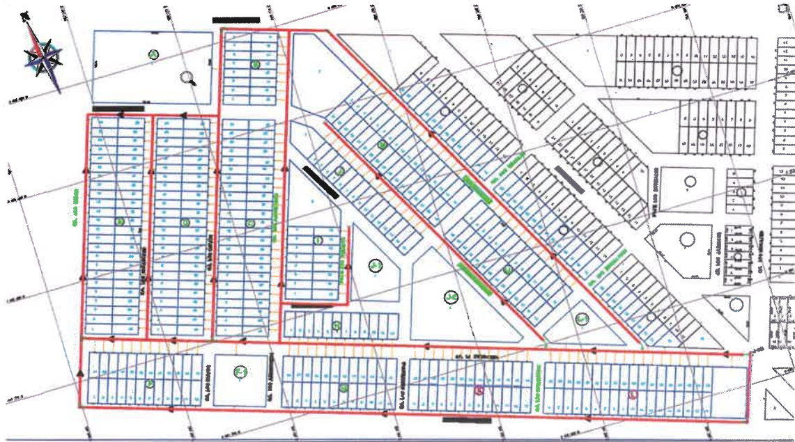
Planta de conexiones domiciliarias de agua potable.
