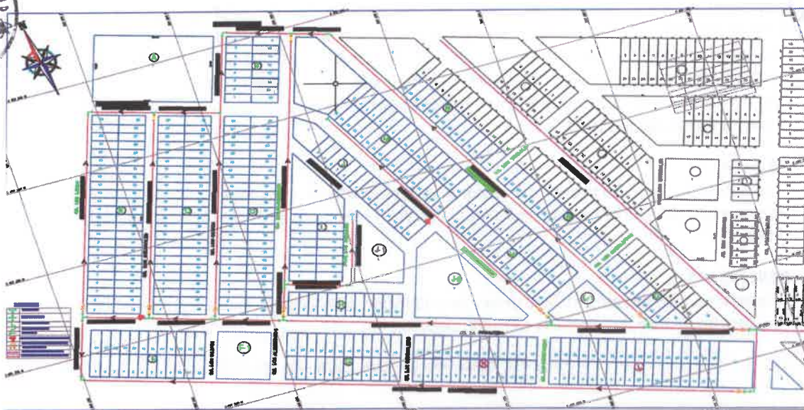
Planta redes de distribución de agua potable.
